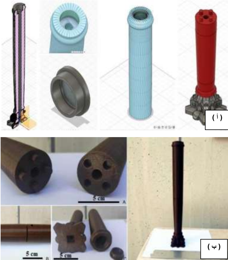
الشكل ٢، (أ) يوضح مراحل النمذجة الرقمية لعمود مبنى تاريخي. (ب) يوضح النموذج المطبوع بواسطة الطباعة الثلاثية الأبعاد. (١٤)
