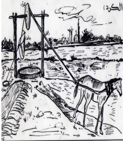
شكل (١) مخطط يمثل كيفية اداء الكرود لعمله
